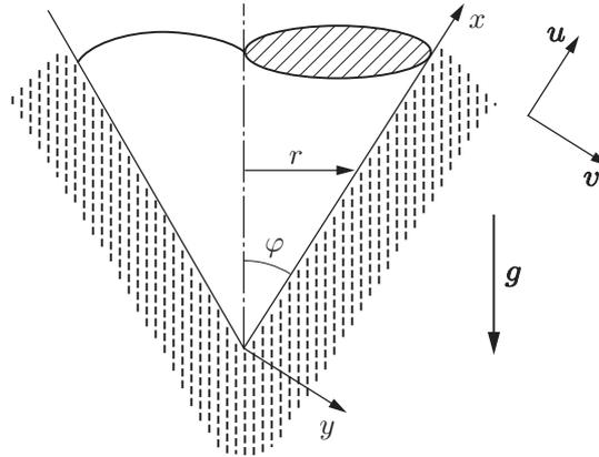
Рис. 1. Схема задачи и система координат
