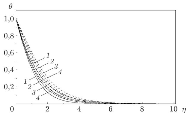
Рис. 4. Зависимость температуры от параметра  $\eta$  при  $R = 1$ ,  $\lambda = 1/3$ ,  $\alpha = 0,2$  и различных значениях  $n$ :
