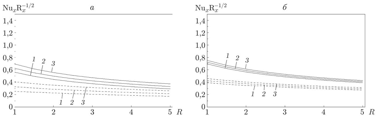
Рис. 7. Зависимость локального числа Нуссельта от параметра  $R$  при  $\lambda = 1/3$  и различных значениях  $\alpha$ :
