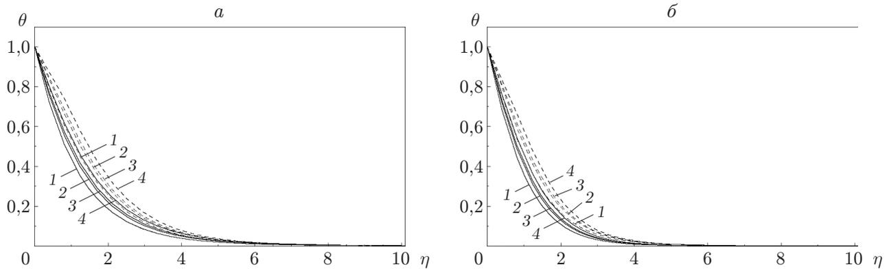
Рис. 3. Зависимость температуры от параметра  $\eta$  при  $R = 1$ ,  $\alpha = 0,2$  и различных значениях  $\lambda$ :
