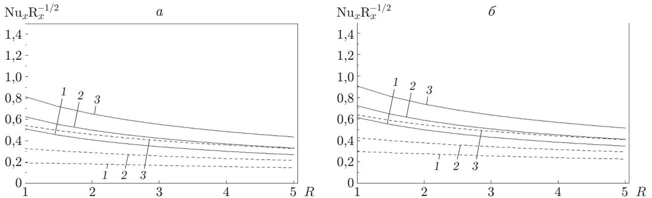
Рис. 6. Зависимость локального числа Нуссельта от параметра  $R$  при  $\alpha = 0,2$  и различных значениях  $\lambda$ :
