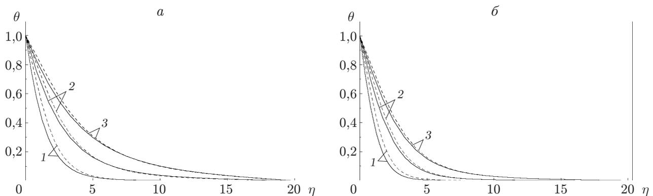
Рис. 5. Зависимость температуры от параметра  $\eta$  при  $\lambda = 1/3$ ,  $\alpha = 0,2$  и различных значениях  $R$ :
