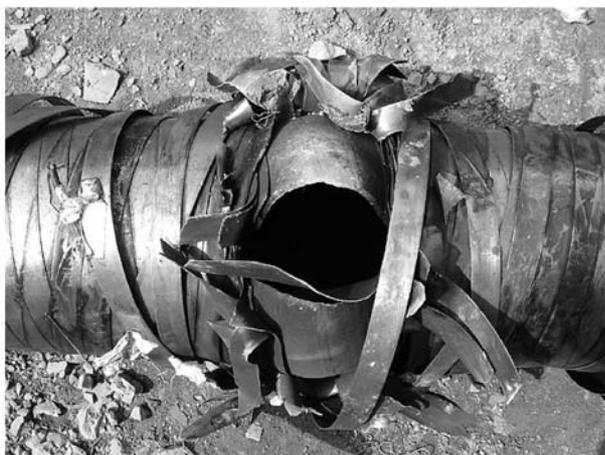
Рис. 2. Разрыв камеры I
