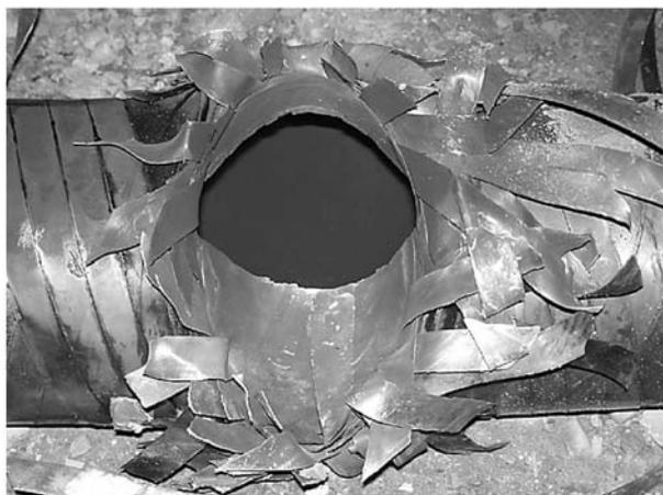
Рис. 4. Разрыв камеры III
