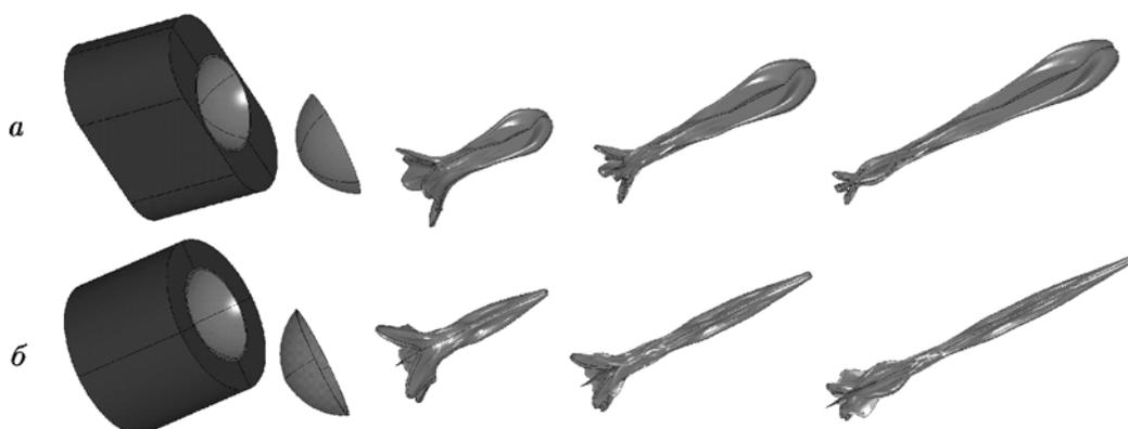
Рис. 9. Формирование несимметричной (а) и симметричной относительно оси (б) стержнеподобных струй
