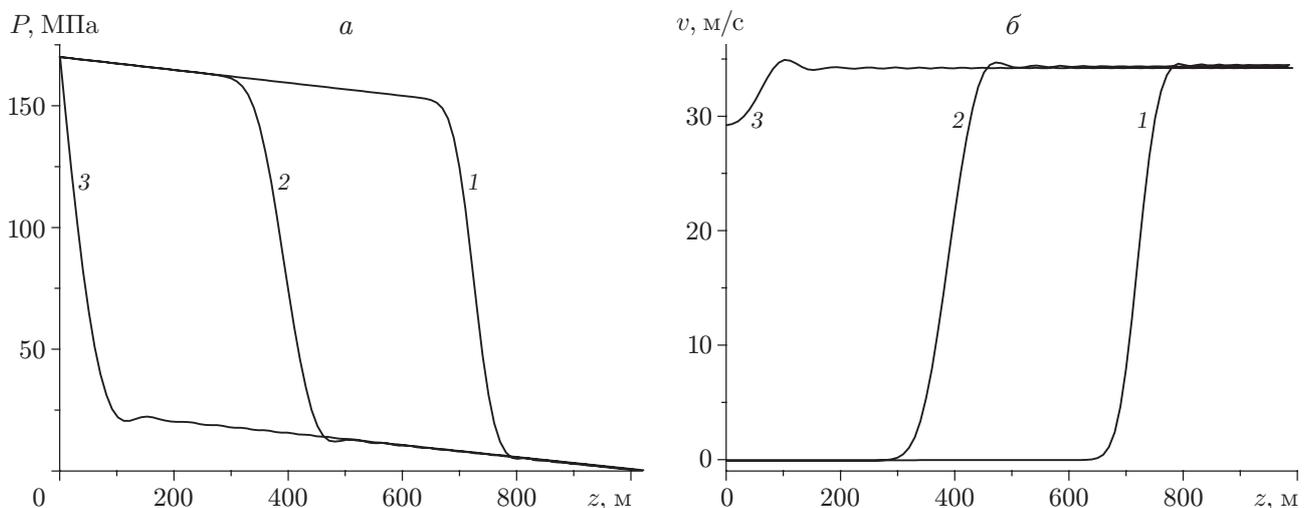
Рис. 4. Зависимость давления (а) и скорости магмы (б) от  $z$  для различных моментов времени:
