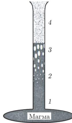
Рис. 1. Схема развития кавитации в магме при динамической разгрузке:
