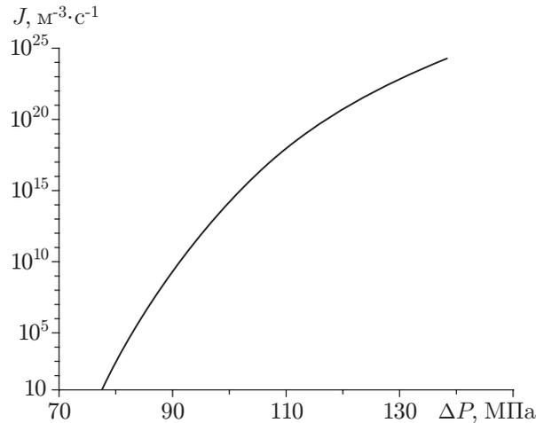
Рис. 2. Зависимость частоты нуклеации от пересыщения
