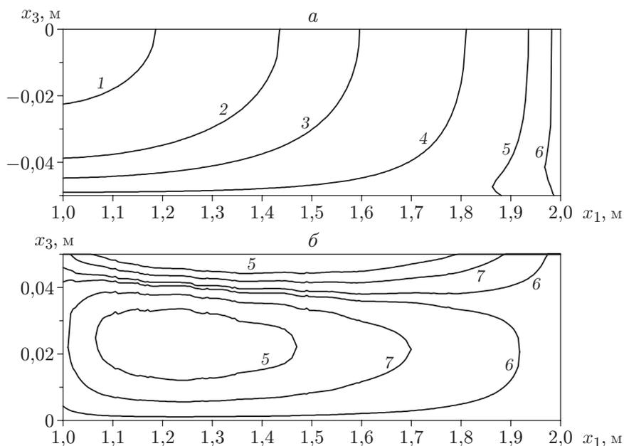
Рис. 4. Изолинии интенсивности скорости деформации установившейся ползучести в радиальном поперечном сечении металлокомпозитной пластины типа I толщиной  $2h = 10$  см, рассчитанные по структурной модели 3:
