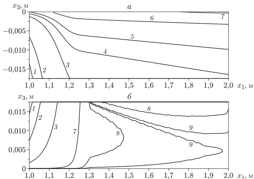
Рис. 5. Изолинии интенсивности скорости деформации установившейся ползучести в радиальном поперечном сечении металлокомпозитной пластины типа I толщиной  $2h = 3,5$  см, рассчитанные по структурной модели 1:
