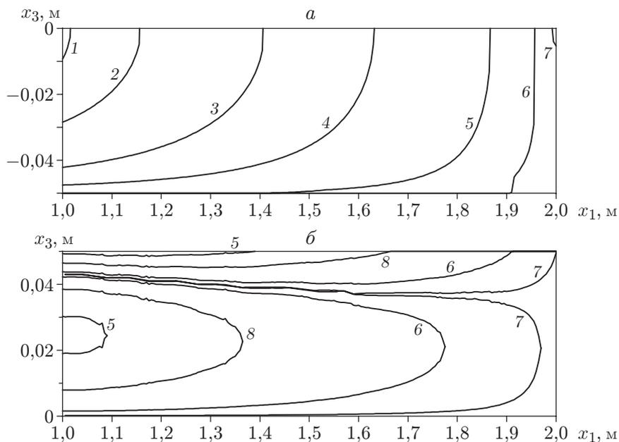
Рис. 3. Изолинии интенсивности скорости деформации установившейся ползучести в радиальном поперечном сечении металлокомпозитной пластины типа I толщиной  $2h = 10$  см, рассчитанные по структурной модели 1:
