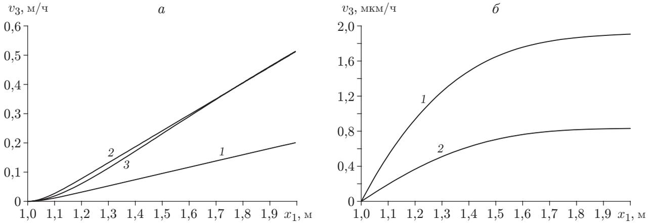
Рис. 2. Зависимость скорости прогиба ползучести от полярного радиуса для относительно тонких ( $2h = 3,5$  см) (а) и толстых ( $2h = 10$  см) (б) пластин типа I:
