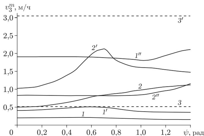
Рис. 1. Зависимость максимальной скорости прогиба ползучести от угла спирального армирования кольцевых пластин:
