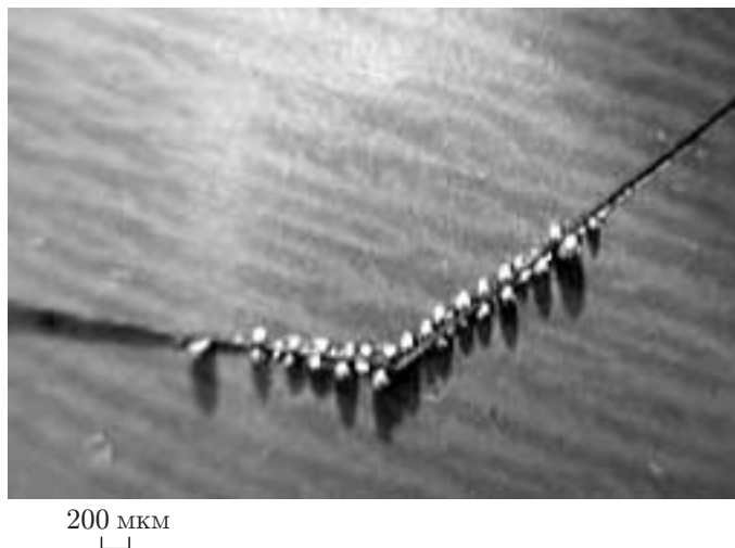
Рис. 1. Образование грата на тыльной стороне реза при газолазерной резке листа из электротехнической стали (толщина листа h = 0,5 мм, мощность лазера W = 800 Вт, скорость резки U = 9 м/мин, давление p = 0,6 МПа, рабочий газ — азот)
