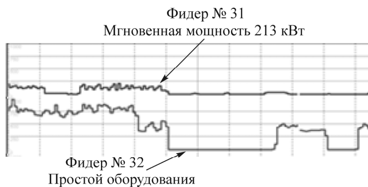
Рис. 2. Окно отображения графиков потребляемой мощности 31 и 32 фидеров
