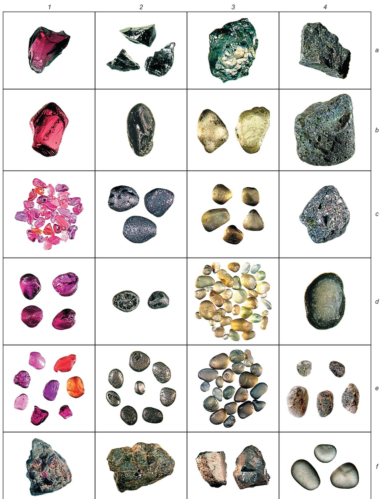
**Рис. 2. Оптические микрофотографии индикаторных минералов в процессе эксперимента.**
