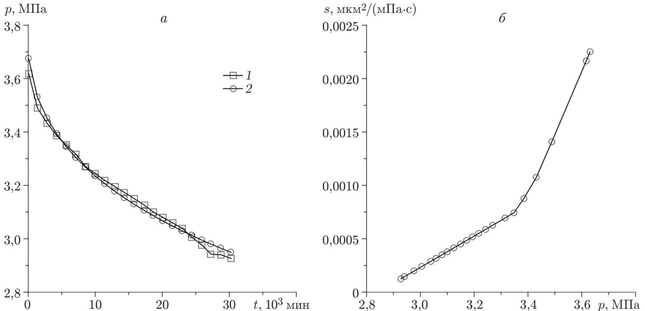
Рис. 2. Кривая откачки  $p(t)$  (а) и расчетная зависимость  $s(p)$  (б) для горизонтальной скважины 1947:
