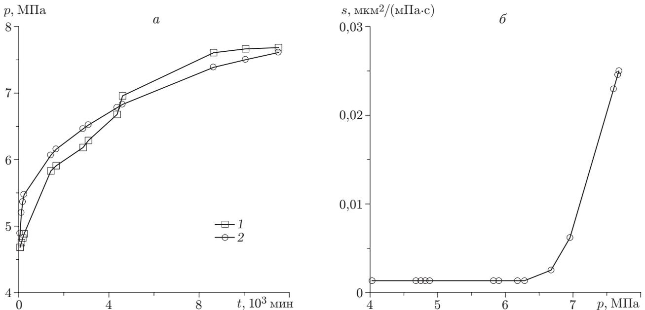
Рис. 1. Кривая восстановления давления  $p(t)$  (*a*) и расчетная зависимость  $s(p)$  (*б*) для горизонтальной скважины 13473:
