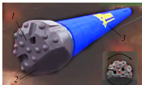
Рис. 4. Погружной пневмударник, реализующий метод “карвинга”: 1 — буровая коронка; 2 — клин; 3 — пневмударник
