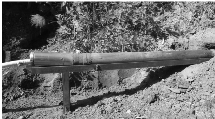
Рис. 7. Исследование процесса изменения траектории проходки скважины в грунте естественного сложения
