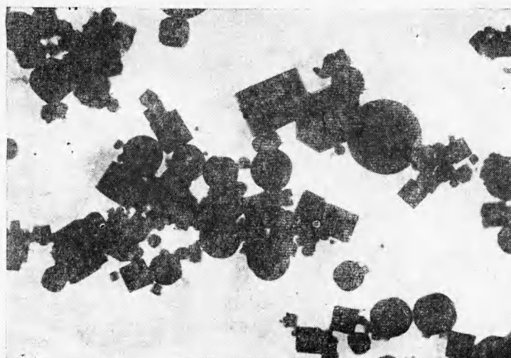
Рис. 1. Вид продуктов парофазного окисления магния под электронным микроскопом, \times 10^4 .
