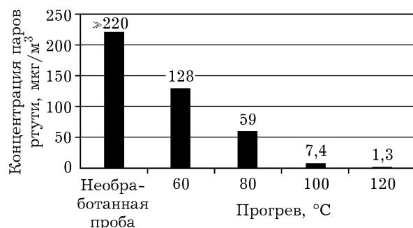
Рис. 2. Концентрация паров ртути в реакторах, прогретых при разной температуре, и в необработанной навеске
