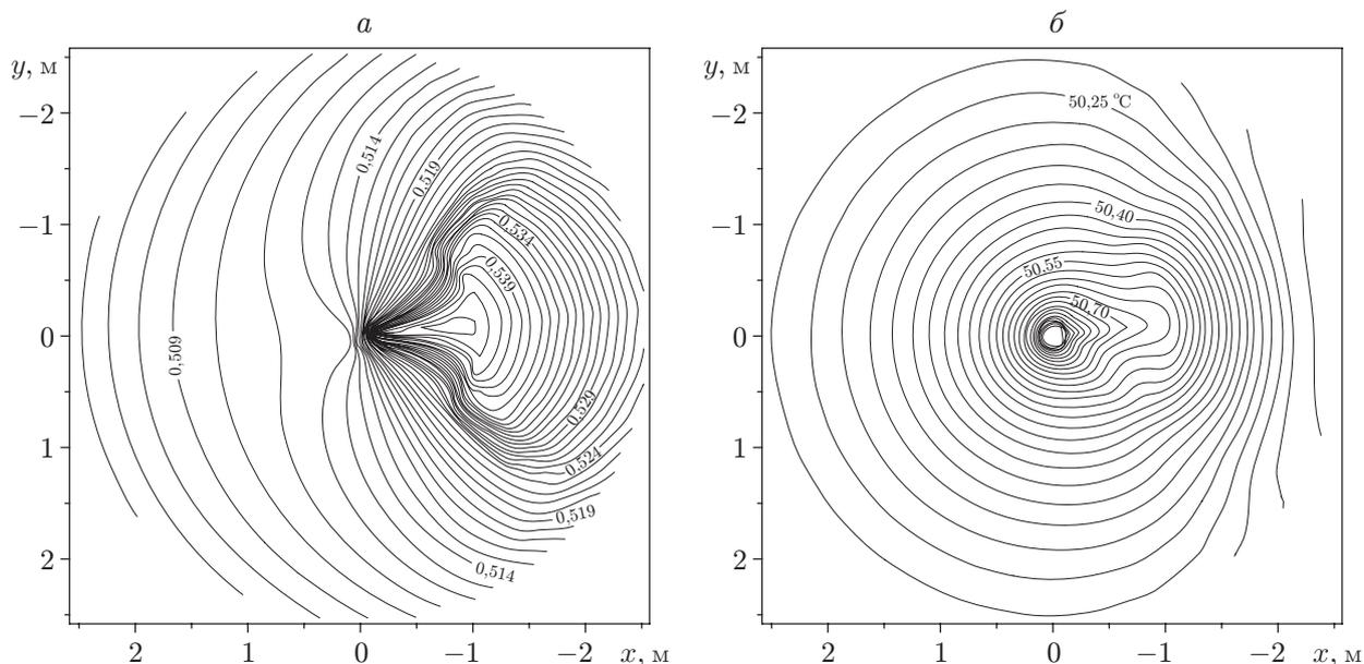
Рис. 3. Изолинии нефтенасыщенности  $S_1$  (а) и температуры  $T$  (б) в окрестности скважины при  $k_H = 0,1K$
