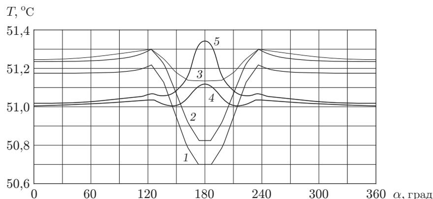
Рис. 4. Угловое распределение температуры на выходе из пласта при  $k_H = 0,1K$ ,  $\alpha_H = 60^\circ$  в различные моменты времени:
