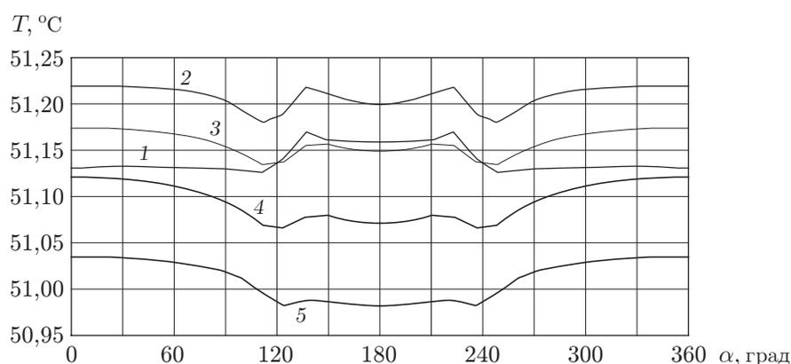
Рис. 5. Угловое распределение температуры на выходе из пласта при  $k_H = 10K$ ,  $\alpha_H = 60^\circ$  в различные моменты времени:
