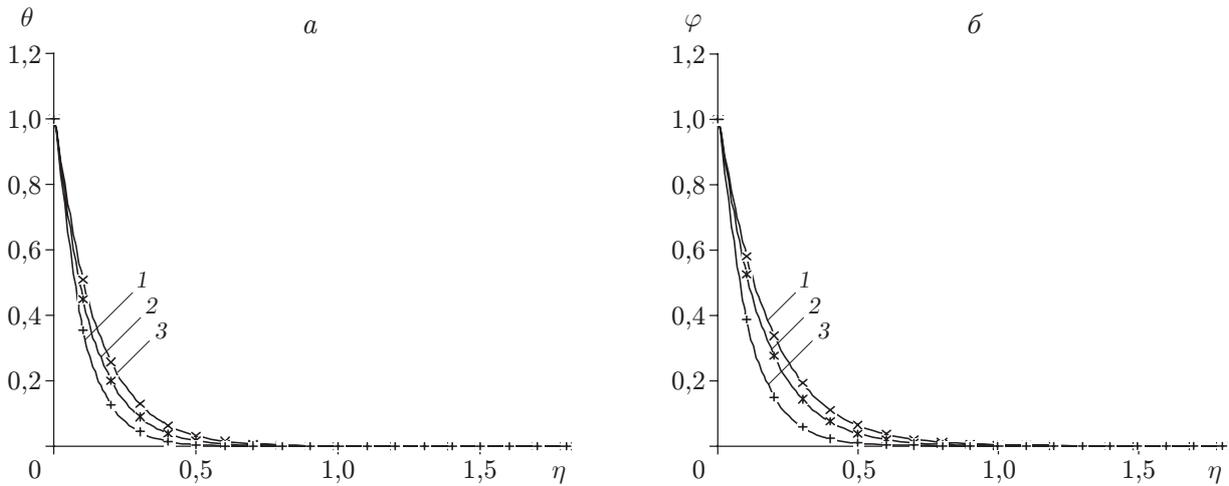
Рис. 3. Профили температуры (*a*) и относительного объема наночастиц (*б*) при  $Pr = 2,0, Le = 3,0, N_t = 1,0, S = 2,0, \lambda = 1,0, \gamma = 1,0, N_r = 0,5$  и различных значениях  $N_B$ :
