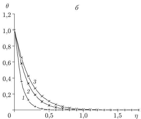
Рис. 6. Профили скорости (а) и температуры (б) при  $Pr = 2,0$ ,  $Le = 3,0$ ,  $N_B = 1,0$ ,  $S = 2,0$ ,  $\lambda = 1,0$ ,  $N = 1,0$ ,  $N_r = 0,5$  и различных значениях  $M$ : 1 —  $M = 0,5$ ; 2 —  $M = 3,0$ ; 3 —  $M = 4,0$
