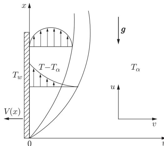
Рис. 1. Физическая модель течения в пограничном слое на вертикальной растягивающейся пористой поверхности
