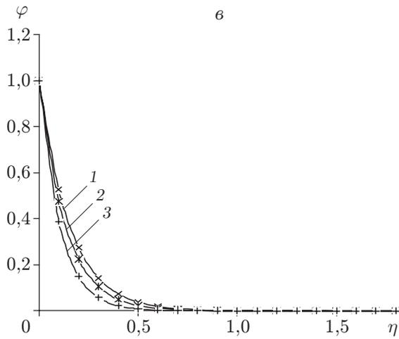
Рис. 5. Профили скорости (а), температуры (б) и относительного объема наночастиц (в) при  $Pr = 2,0$ ,  $Le = 3,0$ ,  $N_B = 1,0$ ,  $S = 2,0$ ,  $\lambda = 1,0$ ,  $N = 1,0$ ,  $N_r = 0,5$  и различных значениях  $\zeta$ : 1 —  $\zeta = 0,5$ ; 2 —  $\zeta = 1,0$ ; 3 —  $\zeta = 3,0$
