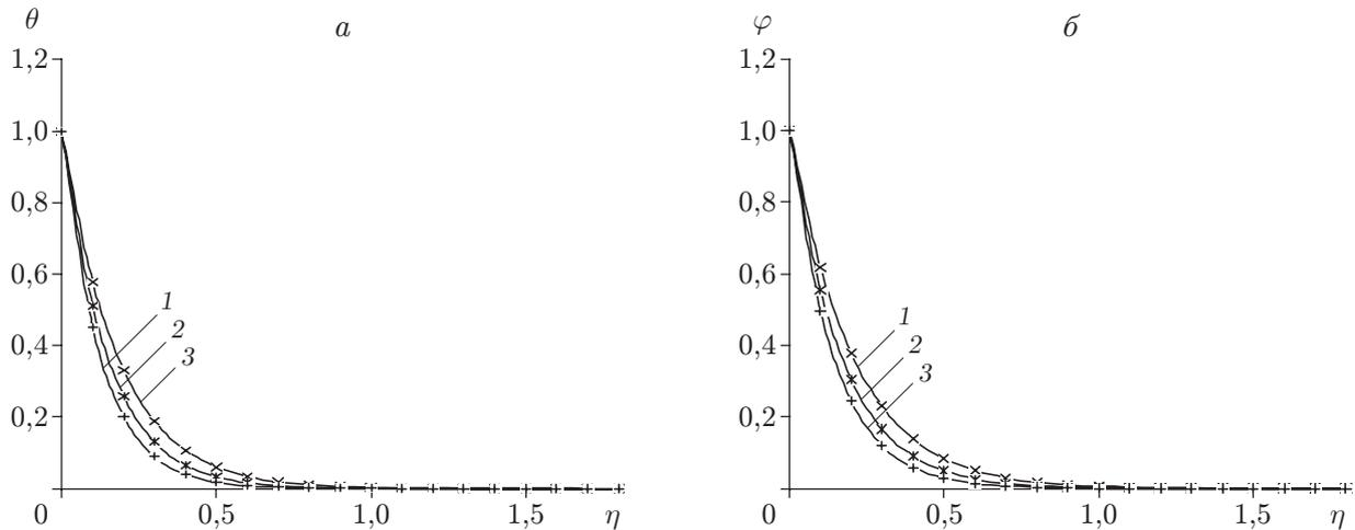
Рис. 4. Профили температуры (*а*) и относительного объема наночастиц (*б*) при  $Pr = 2,0$ ,  $Le = 3,0$ ,  $N_B = 1,0$ ,  $S = 2,0$ ,  $\lambda = 1,0$ ,  $\gamma = 1,0$ ,  $M = 1,0$ ,  $N_r = 0,5$  и различных значениях  $N_t$ :
