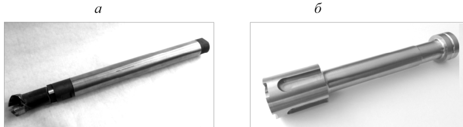
Рис. 2. Экспериментальный образец малогабаритного погружного пневмоударника АШ43Т (а) с ударником из сплава ОТ4-1 (б)
