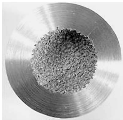
Рис. 9. Диаметральный разрез шара после взрывного нагружения
