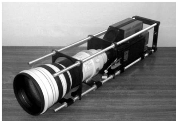
Рис. 7. Внешний вид модуля четырехкадровой электронно-оптической камеры
