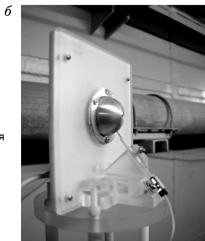
Рис. 21. Схема (а) и фотография (б) экспериментальной сборки с оболочкой из алюминиевого сплава АМг-6:
