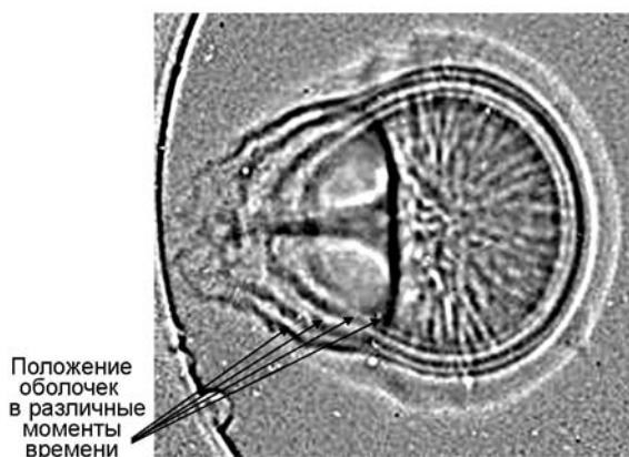
Рис. 24. Взаимодействие сформировавшейся кумулятивной струи с противоположными направлениями инициирования стенками оболочек: съемка проводилась в стробоскопическом режиме камерой с открытым затвором, выполнена С. А. Картановым и М. В. Таченко
