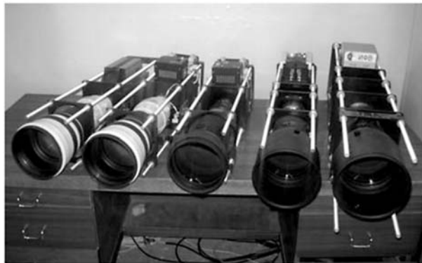
Рис. 6. Внешний вид двухкадровых модулей системы регистрации протонографических изображений
