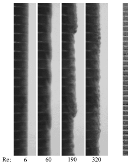
Рис. 4. Профили волн при стекании пленки по поверхностям вертикальной трубы с микротекстурой 0,35 мм в диапазоне изменения числа Рейнольдса ( Re = 4q/\nu ) от 6 до 320 (шаг штрихов масштабной линейки равен 1 мм).
