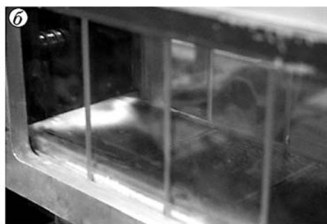
Рис. 2. Внешний вид пламени в пограничном слое с горением этанола за уступом высотой 4 мм: а — скорость обтекания (20 м/с) меньше скорости срыва пламени, б — после срыва пламени (25 м/с)
