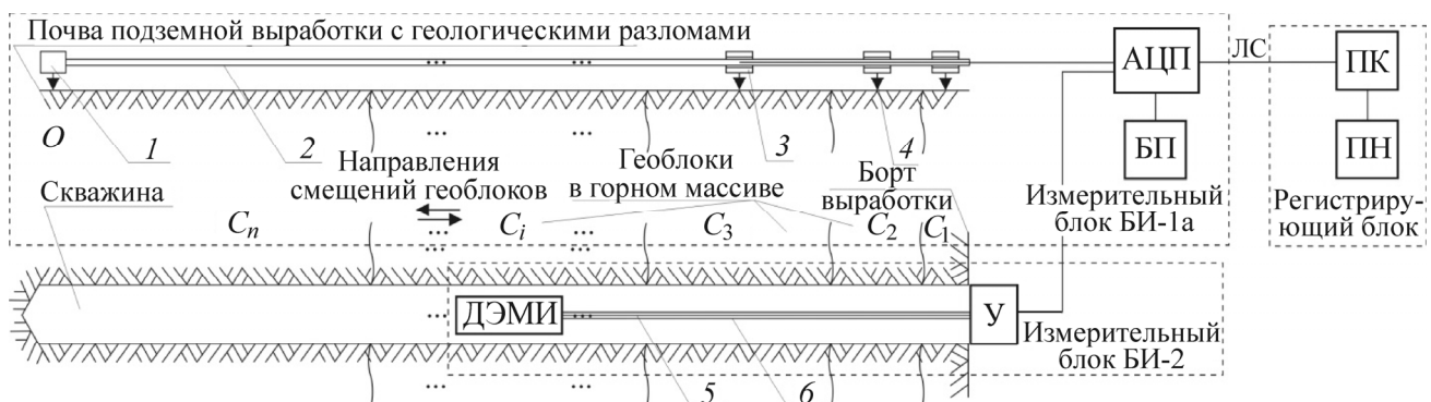
Рис. 9. Функциональная схема измерительной подсистемы контроля деформационных и электромагнитно-эмиссионных процессов в массиве горных пород
