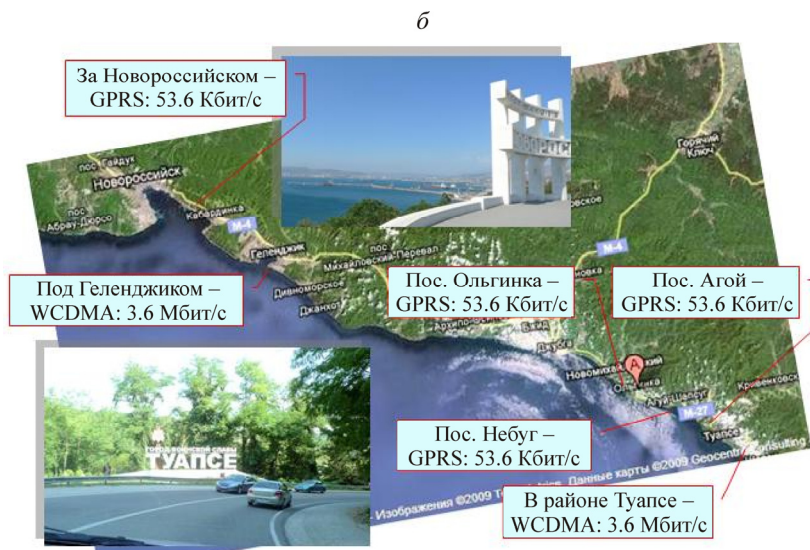
Рис. 25. Сейсмостанция “ЛАВА-СМС” в режиме передачи сейсмической информации в реальном масштабе времени по VPN-сети Интернета (1) с использованием сотовой связи (а) и обработка VPN-соединений между мобильной сейсмостанцией “ЛАВА-СМС” и VPN-сервером LAVA.RU (б). Для каждой точки указаны тип соединения и скорость передачи канала сотовой связи. Скорость связи по технологии EDGE (2) — 236.8 кбит/с
