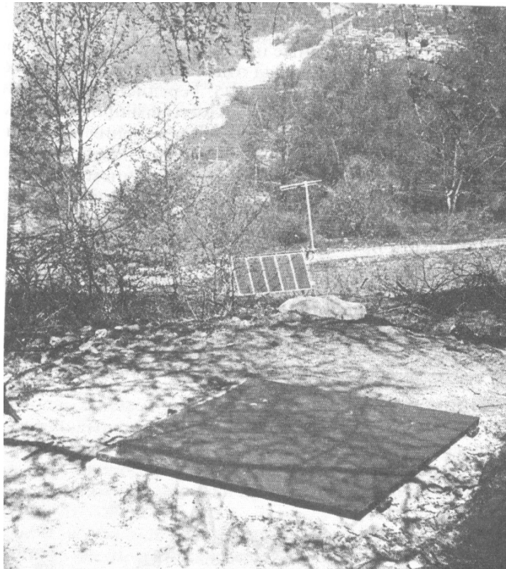
Рис. 30. Внешний вид пункта 2 микросейсмической регистрации в г. Грозио (на заднем плане видны солнечная батарея и передающая антенна)
