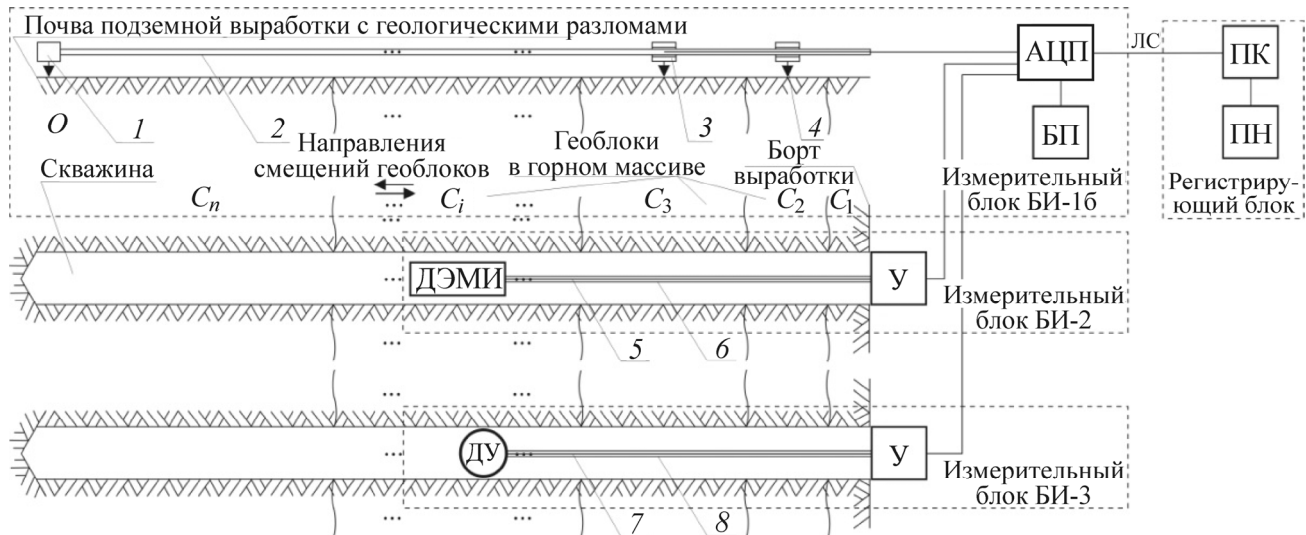
Рис. 11. Схема измерительной системы мониторинга деформационных, электромагнитно-эмиссионных и вибросейсмических процессов в массивах горных пород
