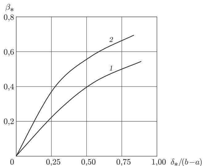
Рис. 4. Зависимость критической тепловой нагрузки  $\beta_*$  от относительной величины раскрытия берегов  $\delta_*/(b-a)$  в центре зоны предразрушения при различных значениях относительной толщины:
