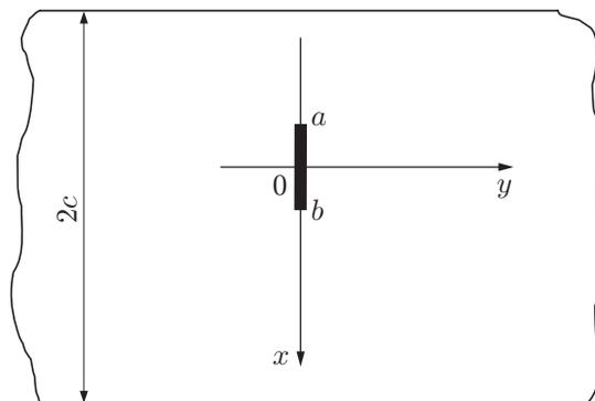
Рис. 1. Схема задачи о зарождении трещины в полосе переменной толщины при неравномерном нагреве
