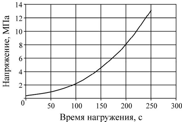
Рис. 4. Диаграмма изменения напряжений на траверсе прессы с течением времени жесткого одноосного нагружения угольного образца № 17 до его разрушения (см. таблицу)
