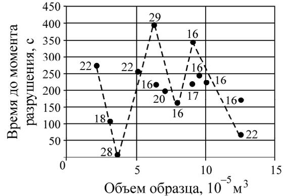
Рис. 5. Изменения временных интервалов до момента разрушения образцов угля от их объемов при скорости одноосного жесткого нагружения  $\sim 3.3 \cdot 10^{-6}$  м/с. Цифры около экспериментальных “точек” показывают значения выхода летучих веществ, %
