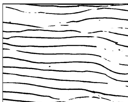
Рис. 4. Оптическое металлографическое изображение сваренных взрывом лент сплава Fe_{40}Ni_{40}P_{14}B_6 ( \times 200 )
