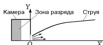
Рис. 1. Схема разрядной камеры
