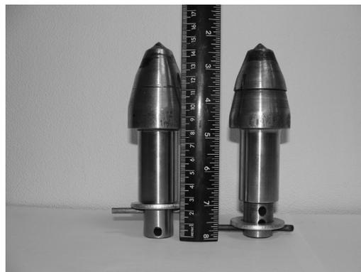
Рис. 7. Резцы многоразового применения на проходческом комбайне КП-21
