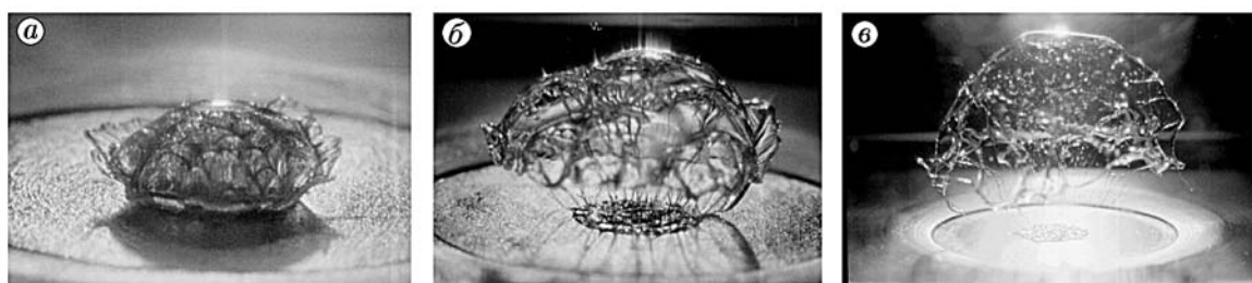
Рис. 6. Динамика структуры капли вязкого раствора при импульсном нагружении в моменты времени 200 (а), 700 мкс (б) и на поздней стадии разрушения t = 1500 мкс (в)
