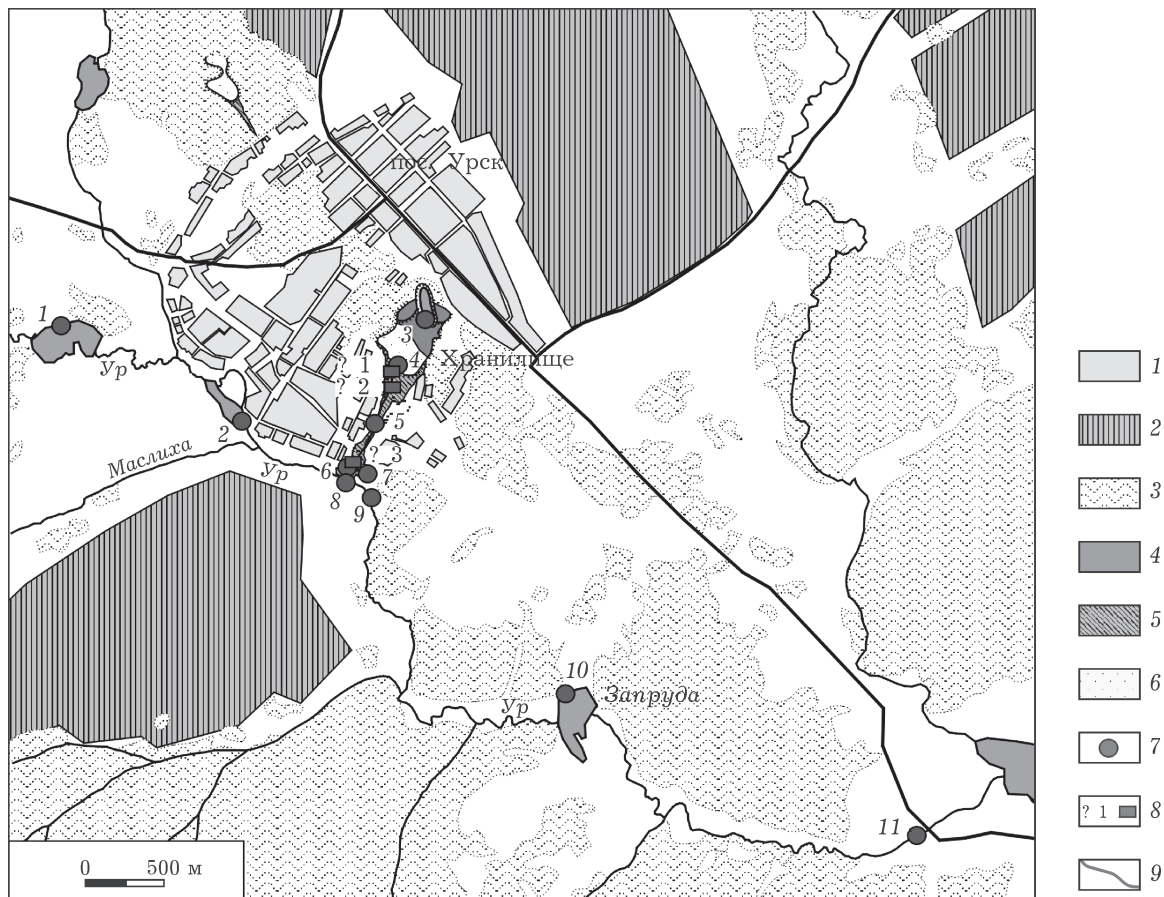
Рис. 1. Схема Урского хвостохранилища, прилегающей территории и отбора проб поверхностных вод и твердого вещества. 1 - жилые кварталы пос. Урск, 2 - пашни, 3 - леса, 4 - породные отвалы, 5 - зона сноса материала отходов, 6 - хвостохранилище, 7 - точки отбора поверхностных вод, 8 - шурфы, 9 - автомобильные дороги, 10 - запруда у драги, 11 - р. Ур.
