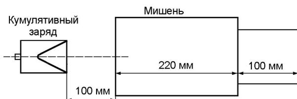
Рис. 10. Постановка баллистического эксперимента
