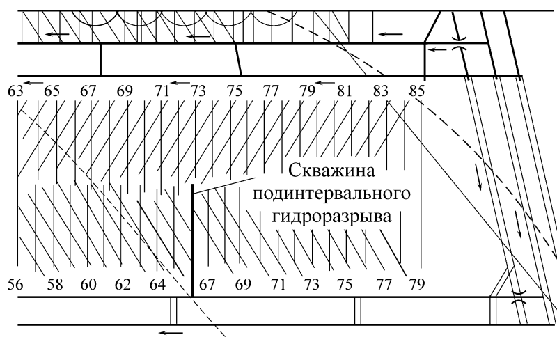
Рис. 3. Схема расположения дегазационной скважины с поинтервальным гидроразрывом
