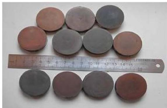
Рис. 3. Композитные диски из взрывных компактов
