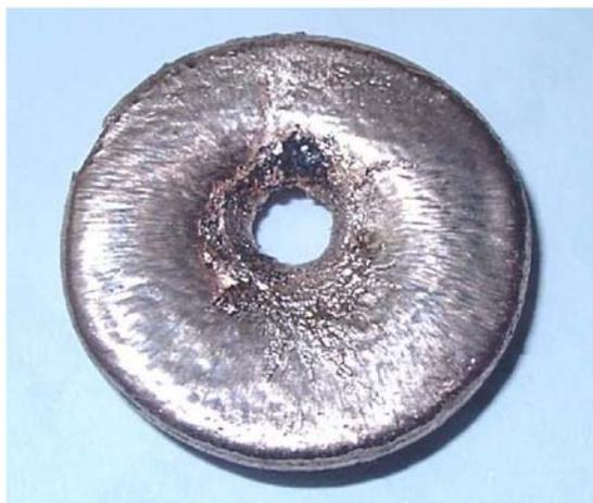
Рис. 2. Деформация медной перегородки с образованием центрального отверстия
