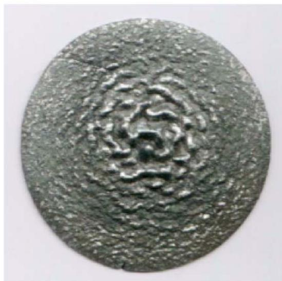
Рис. 1. Волнообразная деформация диска из электротехнической стали Э3412
