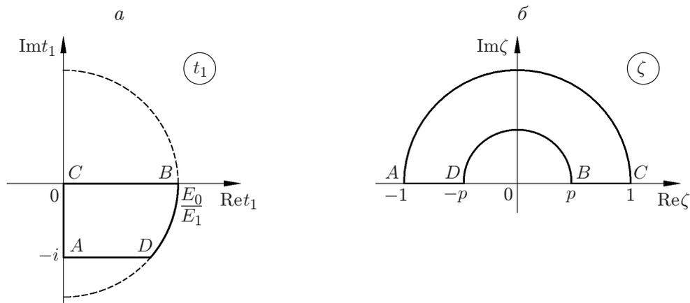
Рис. 2. Формы межэлектродного пространства на параметрических плоскостях  $t_1$  (*a*) и  $\zeta$  (*б*) для стационарной задачи
