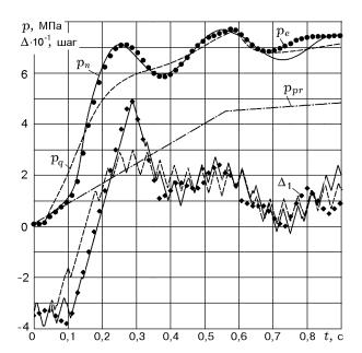
Рис. 8. Процессы регулирования давления в камере сгорания: экспериментальный и полученные по квазистационарной и нестационарной моделям
