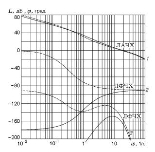
Рис. 4. Логарифмические частотные характеристики системы регулирования давления (1, 3) и камеры сгорания ГГТТ (2): сплошные линии — p=4 МПа,  $\nu>1$ , штриховые — p=8 МПа,  $\nu<1$
