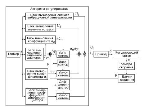
Рис. 1. Функциональная схема системы регулирования давления
