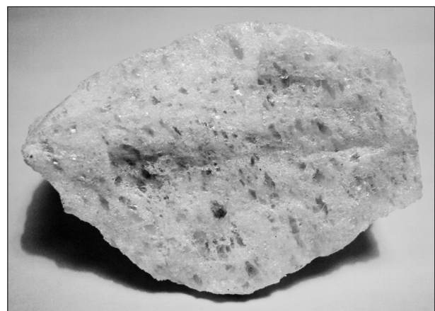
Рис. 6. «Суперкварцит» с порфиroidной структурой, ориентированной вдоль направления скольжения перекрывающей пластины.
