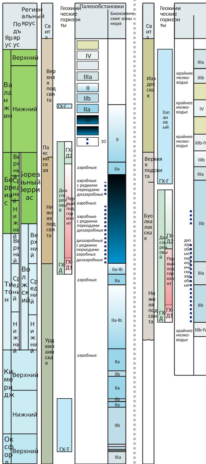
Рис.7. Стратиграфическое положение геохимических горизонтов в разрезах Анабарского залива и р. Оленек.
