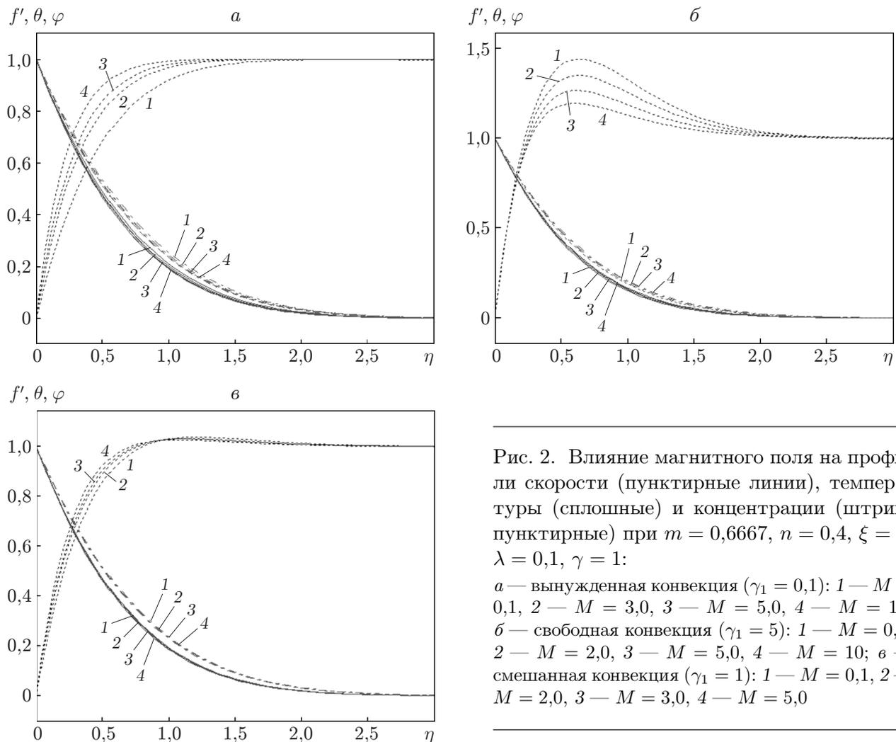
Рис. 2. Влияние магнитного поля на профили скорости (пунктирные линии), температуры (сплошные) и концентрации (штрихпунктирные) при  $m = 0,6667$ ,  $n = 0,4$ ,  $\xi = 1$ ,  $\lambda = 0,1$ ,  $\gamma = 1$ :
