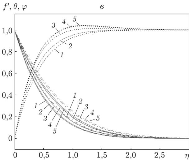
Рис. 3. Влияние показателя в степенном законе скорости свободного потока на профили скорости (пунктирные линии), температуры (сплошные) и концентрации (штрихпунктирные) при  $M = 0,1$ ,  $n = 0,4$ ,  $\lambda = 0,1$ ,  $Sc = 0,62$ ,  $\gamma = 1,0$ :
