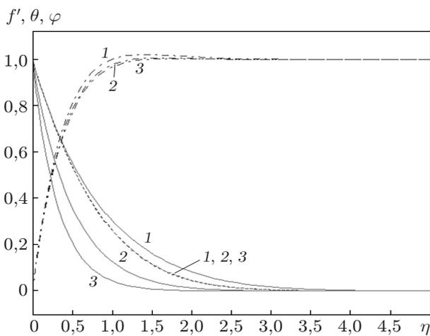
Рис. 4. Влияние числа Шмидта на профили скорости (штрихпунктирные линии), температуры (пунктирные) и концентрации (сплошные) при  $N = 1$ ,  $M = 0,1$ ,  $\lambda = 0,1$ ,  $\gamma_1 = 1$ ,  $m = 0,6667$ ,  $n = 0,4$ ,  $\xi = 0,1$ ,  $\gamma = 1$ :
