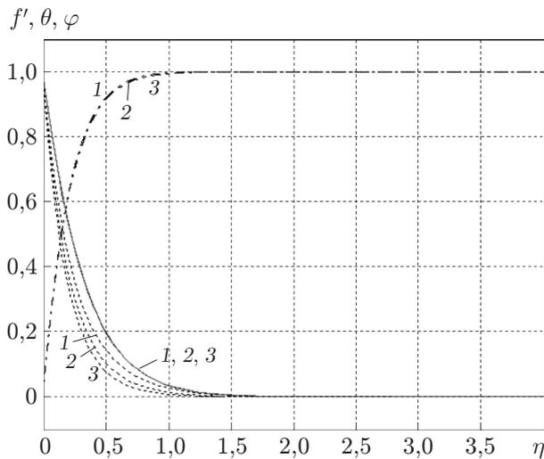
Рис. 5. Влияние наличия химической реакции на профили скорости (штрихпунктирные линии), температуры (сплошные) и концентрации (пунктирные) при  $N = 1$ ,  $M = 0,1$ ,  $\lambda = 0,1$ ,  $\gamma_1 = 1$ ,  $m = 0,6667$ ,  $n = 0,4$ ,  $\xi = 0,1$ :
