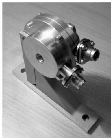
Рис. 1. Конструкция и общий вид коаксиального резонаторного СВЧ-датчика:
