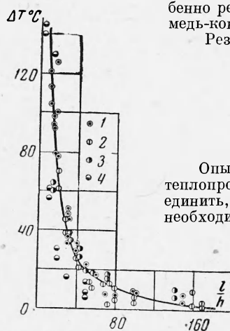
Фиг. 4. Занижение температуры термопарой медь-константан из-за теплопотерь в концы в зависимости от безразмерной глубины погружения: 1 — h = 0.05 \text{ мм} , 2 — h = 0.5 \text{ мм} , 3 — h = 0.7 \text{ мм} , 4 — h = 2.0 \text{ мм}
