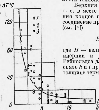
Фиг. 5. Занижение температуры термопарой манганин-константан из-за теплопотерь в концы в зависимости от безразмерной глубины погружения: 1 — h = 0.2 \text{ мм} , 2 — h = 0.6 \text{ мм} , 3 — h = 1.2 \text{ мм}
