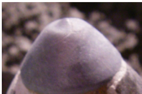
Рис. 6. Выкрашивание вершины режущей вставки
