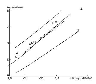
Сравнение рассчитанных адиабат Гюгонио при частичной деструкции за фронтом кристаллической (сплошная линия 2) и жидкой (штриховая линия 2) серы с экспериментальными данными (квадраты и треугольники соответственно):
