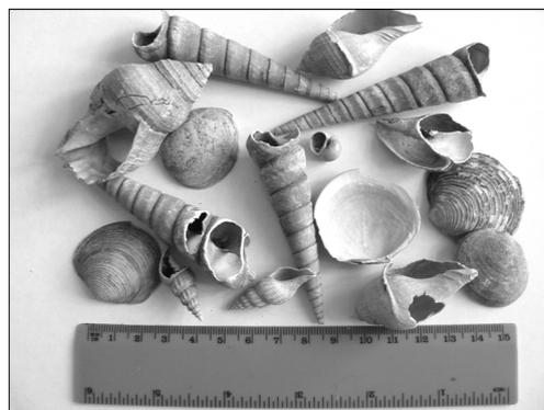
Рис. 5. Створки и раковины малюсков в классе крупности + 0.63 мм
