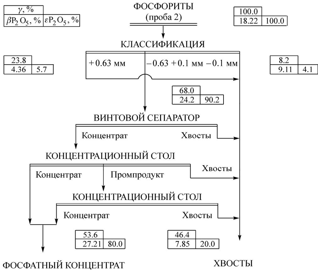
Рис. 4. Схема обогащения пробы 2
