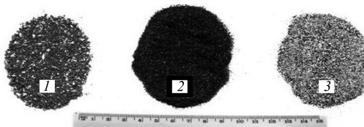
Рис. 6. Продукты гравитационного обогащения фосфоритов: 1 — питание гравитационного цикла; 2 — фосфатный концентрат; 3 — отвальный продукт (хвосты гравитации)
