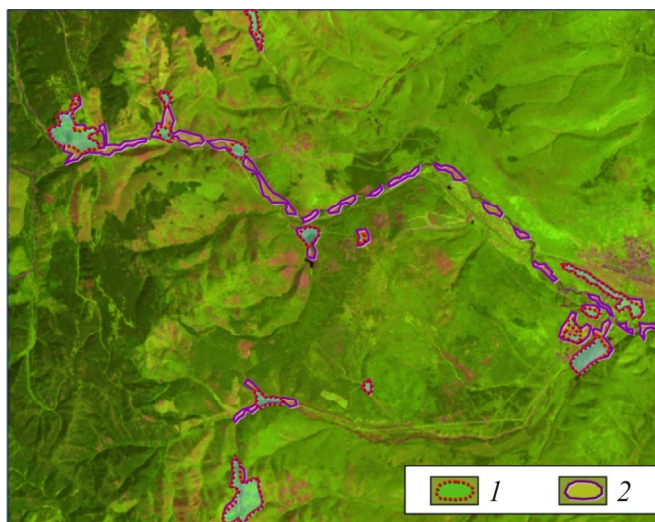
Рис. 4. Результаты дешифрирования многоканального спутникового снимка Landsat 8 и сопоставление результатов с данными за более ранний период. Контурные площади загрязнения поверхности земли: 1 — до катастрофического наводнения 2011 г.; 2 — после наводнения 2011 г.
