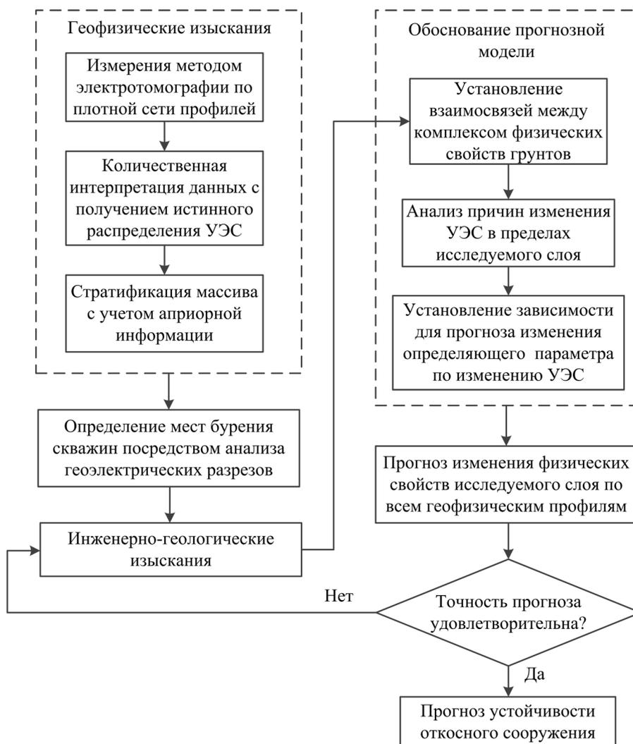
Рис. 1. Алгоритм геолого-геофизического прогноза физико-механических свойств техногенного массива
