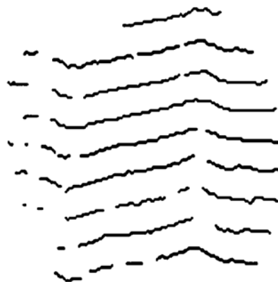
Рис. 3. Картина отклонений муаровых полос после обработки фотографий
