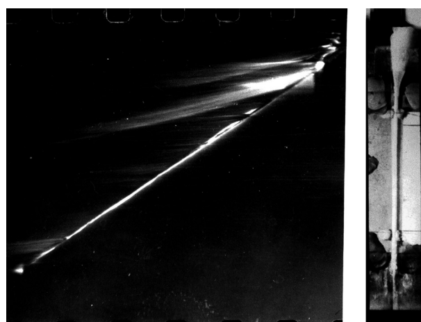
Рис. 4. Фоторегистрограмма детонации раствора (НГЛ + 10 % ГНМ) + 0,59 % ДНТ в трубке из кальки диаметром 2,15 мм:
