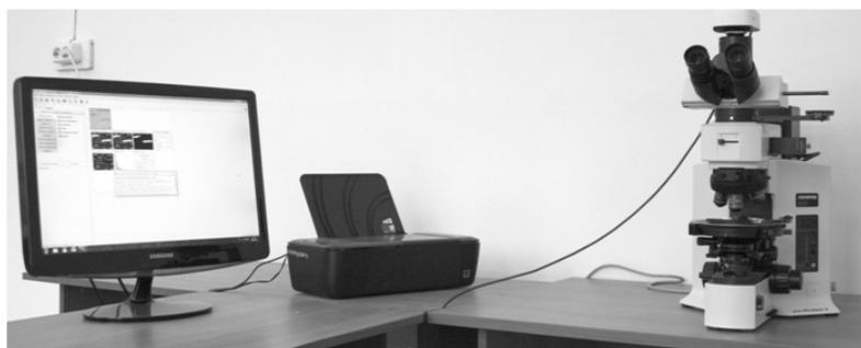
Рис. 5. Инструментально-программный комплекс “Минерал С7” на базе микроскопа OLYMPUS B<sup>X</sup>51 (Госреестр средств измерений РФ № 27438-04. Сертификат Госстандарта RU. С.31.005А № 36493)
