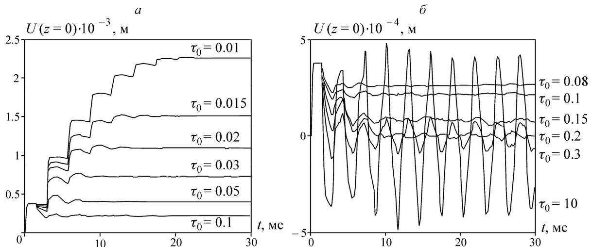
Рис. 7. Осциллограммы перемещений трубы в точке  $z = 0$
