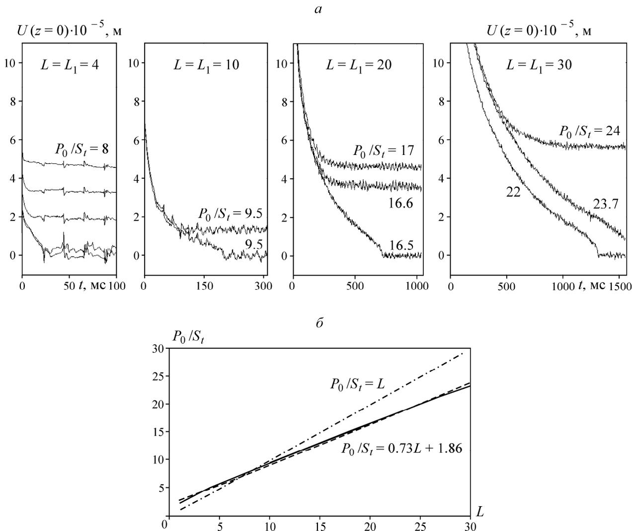
Рис. 10. Осциллограммы перемещений для различных значений амплитуды импульса (а) и зависимость амплитуды импульса, при котором труба начинает проскальзывать, от длины трубы (б)
