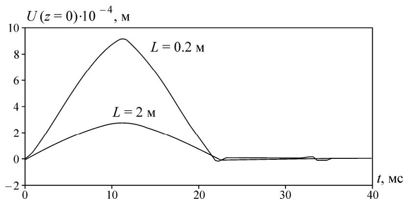
Рис. 5. Осциллограммы перемещений при импульсном воздействии
