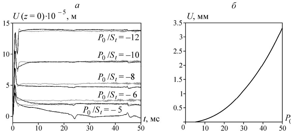
Рис. 9. Осциллограммы перемещений для различных значений амплитуды импульса (а) и зависимость перемещений от амплитуды импульса (б)
