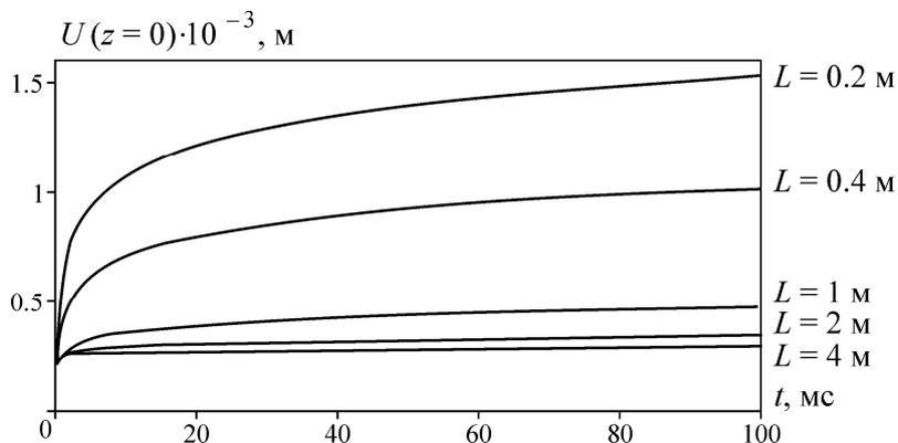
Рис. 4. Осциллограммы перемещений для различных значений длины трубы при ступенчатом воздействии
