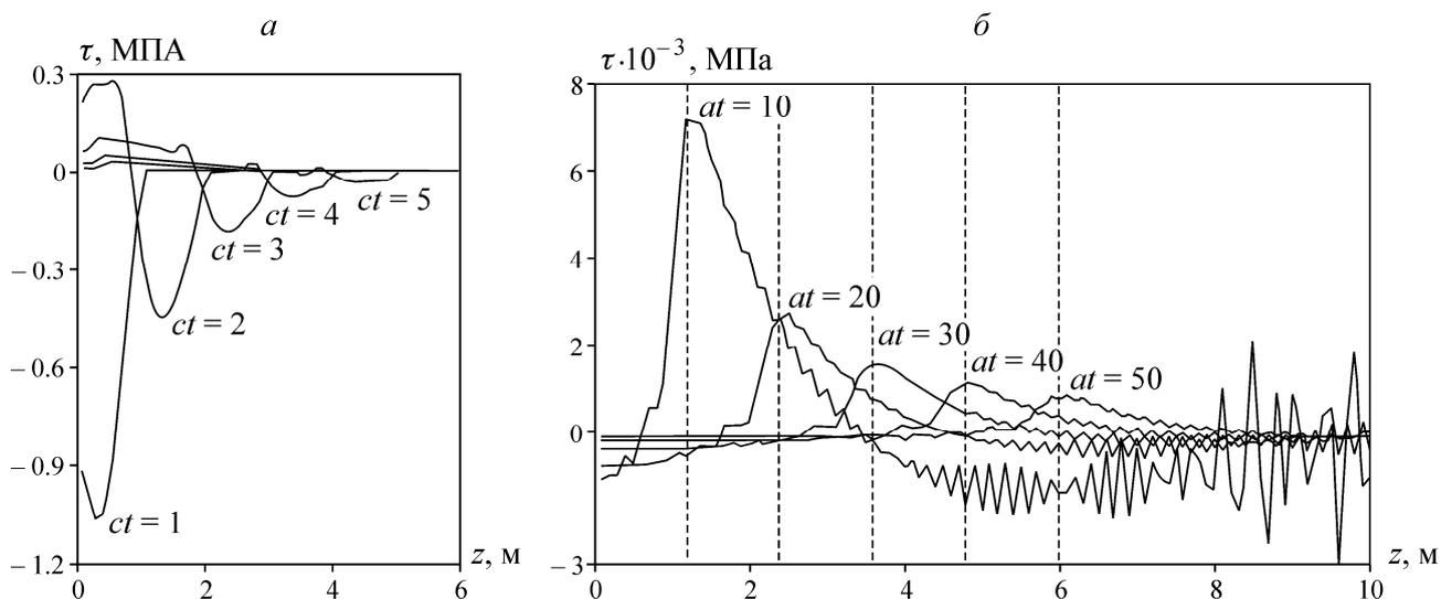
Рис. 6. Эпюры сдвиговых напряжений среды на поверхности трубы в различные моменты времени
