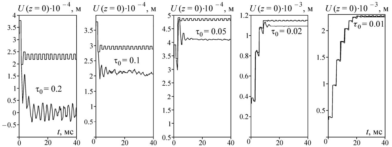
Рис. 8. Осциллограммы перемещений трубы в точке  $z = 0$
