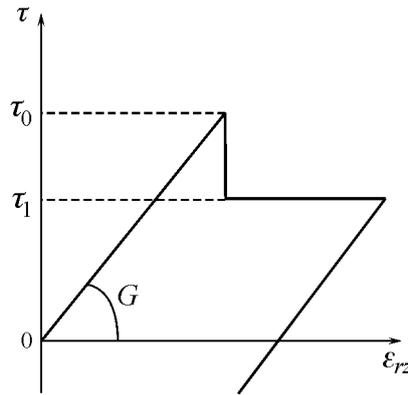
Рис. 1. Зависимость реакции среды от сдвиговой деформации
