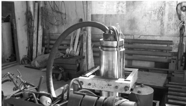
Рис. 1. Пневмомолот “Тайфун-300” на вертикальном стенде
