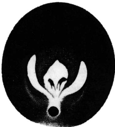
Рис. 2. Фотография сажевого следа вихревой структуры в пламени, содержащей три вихревые ячейки,  $Re = 75$ ,  $Ra = 7 \cdot 10^4$
