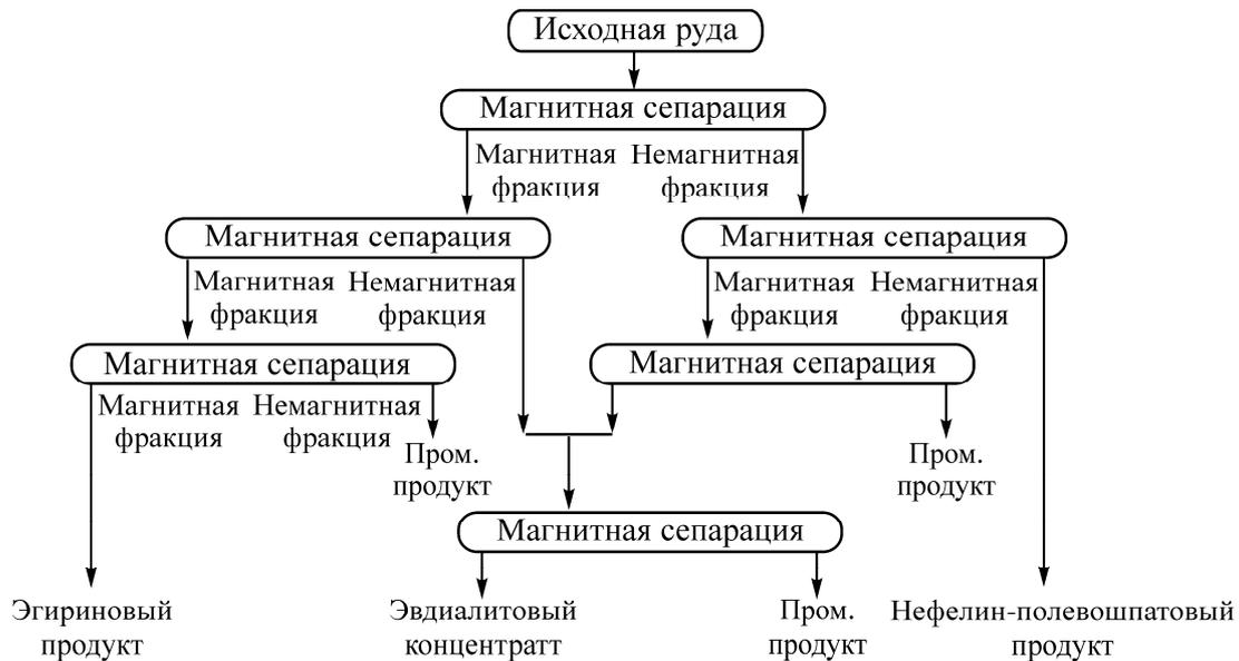
Рис. 9. Схема проведения магнитной сепарации
