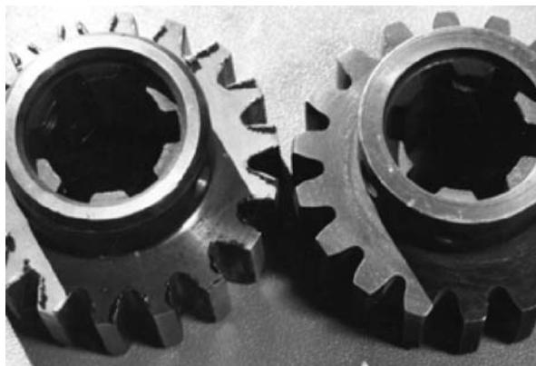
Рис. 15. Удаление заусенцев с помощью газовой детонации:
