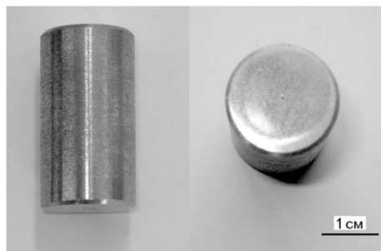
Рис. 2. Образец  $\text{Cu}/\alpha\text{-Al}_2\text{O}_3$  после взрывного компактирования
